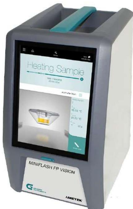
MINIFLASHは、1mLまたは2mLの試料で迅速に引火点測定が可能なMCCCFP法自動引火点試験器です。測定方法は、規定の昇温速度で加熱された試料に高電圧アークを放出します。試料蒸気に引火が発生した際、試料カップ内に急激な圧力上昇が見られ、その温度を引火点と判断します。
